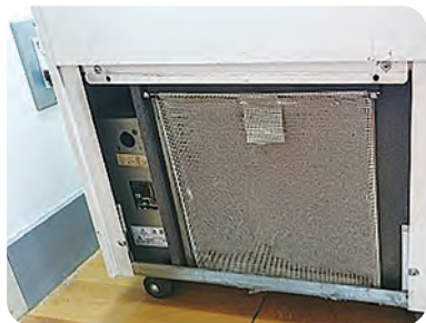
人工気象器の汚れ(凝縮器フィルタ)
